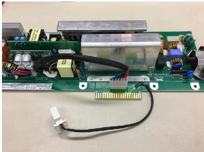
**Anmerkung:** Achten Sie beim Anschluss an den OCPA-Adapter auf die Polarität des Netzsteckers und sowie auf die Position der Stifte (alle Stifte müssen angeschlossen sein).
