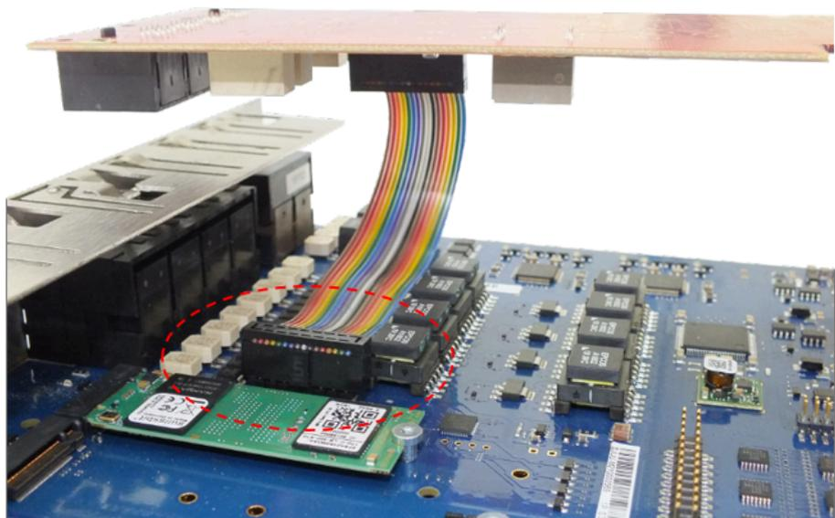
**Abbildung 107: Position des an das Mainboard OCCMAR oder OCCMBR angeschlossenen Verbindungskabels**
