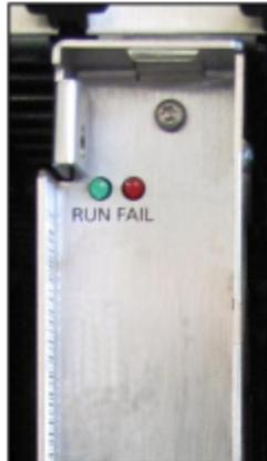
**Abbildung 73: SLCN – LEDs in der Frontblende**
